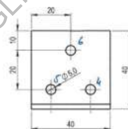
Abb. B. 62 Abmessungen des Winkelverbinders 618 168 40
